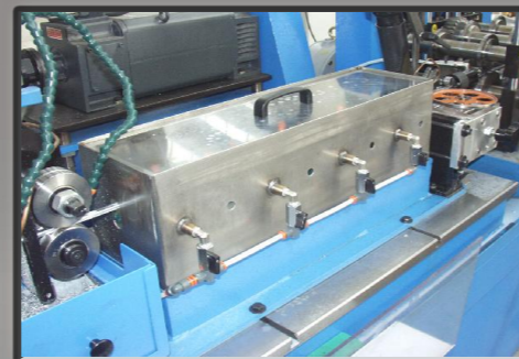
Impianto di raffreddamento
